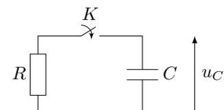
3. On considère le circuit ci-contre. Pour  $t < 0$ , le courant  $i$  est nul et l'interrupteur  $K$  est ouvert. À  $t = 0$ , on ferme l'interrupteur  $K$ . Donner les valeurs de  $i$  à  $t = 0^+$  et pour  $t \rightarrow +\infty$ . Déterminer l'évolution temporelle de  $i$  et tracer son allure.
