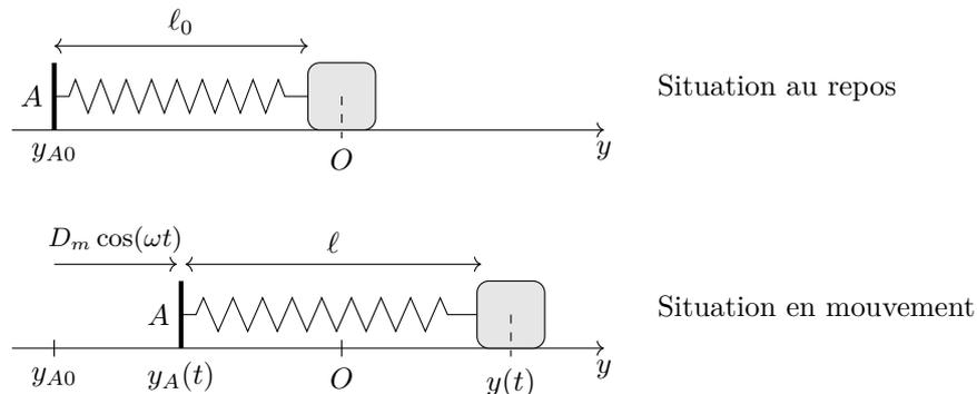
On impose une excitation sinusoïdale au point d'attache  $A$  en l'agitant autour de sa position à l'équilibre de telle sorte que :
